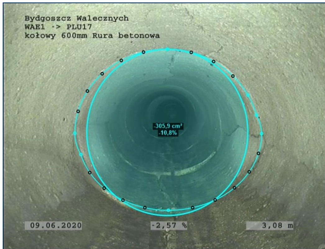
ul. Walecznych - pomiary owalizacji kanału dn 600mm
